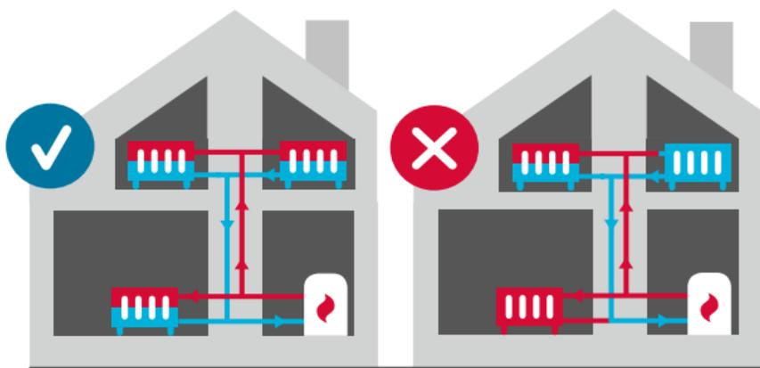
In einem gut eingestellten Heizsystem transportiert die Pumpe warmes Wasser gleichmäßig in alle Räume, während abgekühltes Wasser wieder zurück zum Heizkessel fließt.
